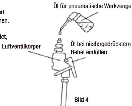
Verwenden Sie wie in Bild 4 gezeigt ein bis zwei Mal pro Monat eine großzügige Menge Hydraulikwerkzeugöl zum Schmieren des Luftventils.
